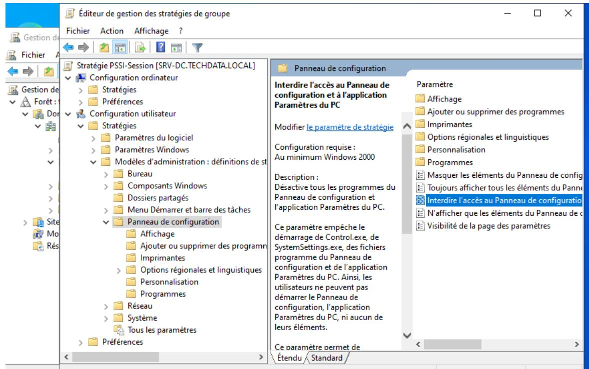
Pour vérifier le bon fonctionnement des GPO, on effectue sur la VM client un gpupdate/force, puis on essaie d'accéder au panneau de configurations :
